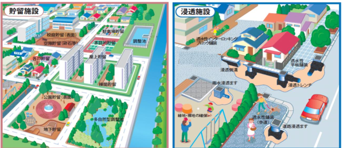
図 - 3 雨水貯留浸透施設の主なもの
