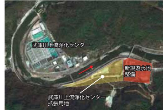
遊水地は、洪水の一部を、遊水地に一旦流入させることで、下流へ流れる洪水を減らす施設です。
