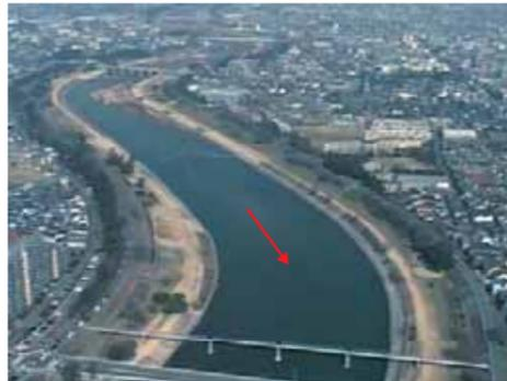
河道掘削を行い、その分担当量 3,200m<sup>3</sup>/s の洪水を安全に流すようにします。
