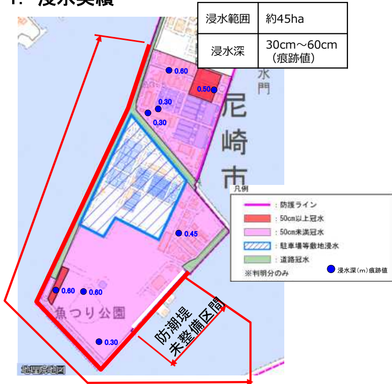
主に越波により浸水した区間
