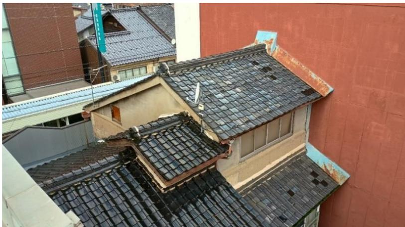
図 7-12：建物後部の現況写真。奥の北側 RC 造物件には 3 階の増築部分が、手前の南側木造物件では山型のパラペットが確認できる。
