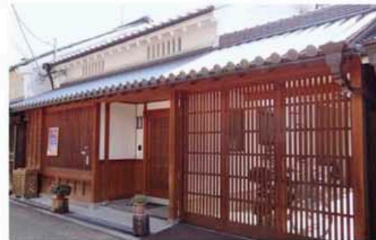
壁面の連続性を確保した駐車場の例。外壁面の連続性に配慮し、建物の下屋庇を連続させた門とその建具に格子を設けることにより、統一感のある優れた通り景観を創出している。
