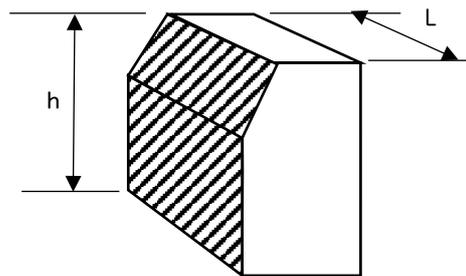
斜線部分を1壁面とし、面積 =  $h \times L$
