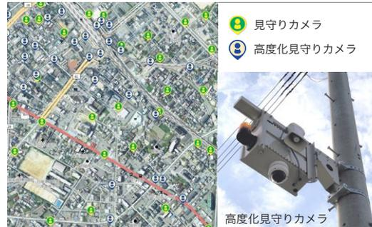
市内の電柱等に「見守りカメラ」を設置し、ビーコンタグを持った子どもや高齢者等が付近を通過すると家族が位置情報履歴を確認できる見守りサービスを提供。さらに、AIを搭載した「高度化見守りカメラ」が犯罪の抑止や交通事故の防止（悲鳴や車両接近を検知）、にぎわいづくり（人流データ）に活用されています。
