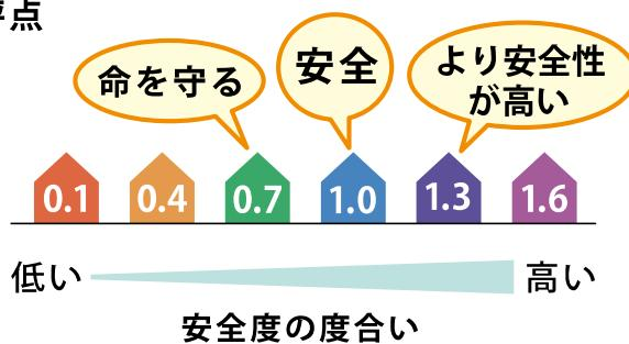
耐震診断をすると、**0.4、0.7、1.0**のような点数ができます。この点数は、現在建築基準法で定められている最低限の強さを1.0としたときのあなたの家の強さの比率を表しています。評点0.5ということは、耐震基準で定める半分の強さしかないということになります。また、評点0.7は命を守るために最低限必要な評点と言われており、評点1.3になるとより安全性が高いと言えます。
