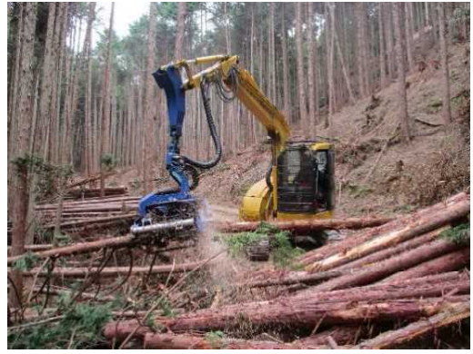
高性能林業機械（ハーベスタ）による原木搬出作業
