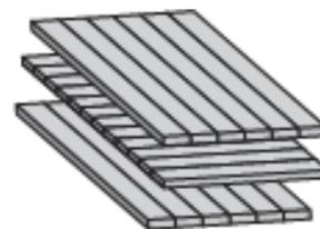
図2 幅方向に接合した板を直交するように積層接着（3層）
