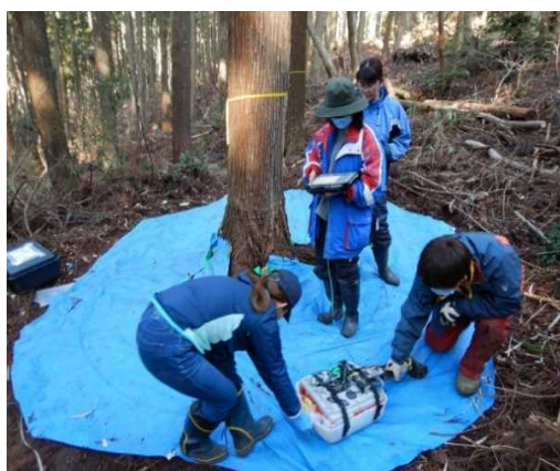
樹木根系の地中レーダ調査
