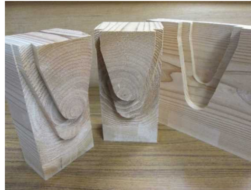
梁仕口をV字型に加工して接合強度を高めた「Tajima TAPOS」（特許）
