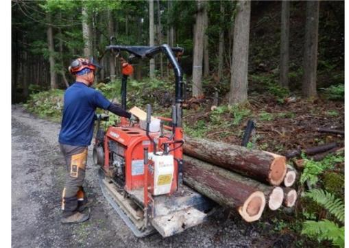
自伐型林家による小型集材機を用いた間伐材の搬出
