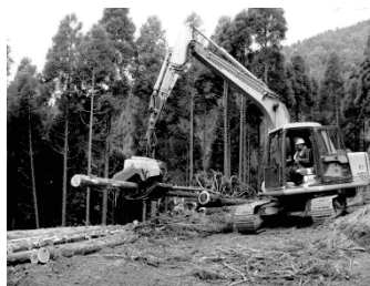
プロセッサ (枝払い玉切りを行う機械)
