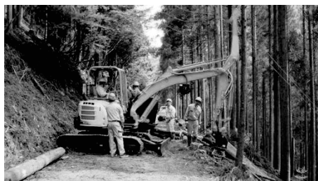
スイングヤーダ (木を山から効率的に搬出する機械)
