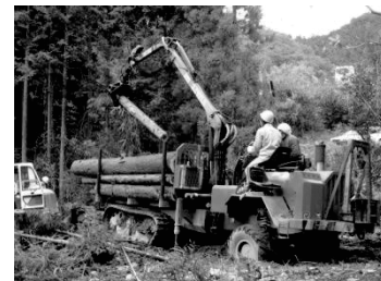
フォワーダ (積み込み運搬を行う機械)
