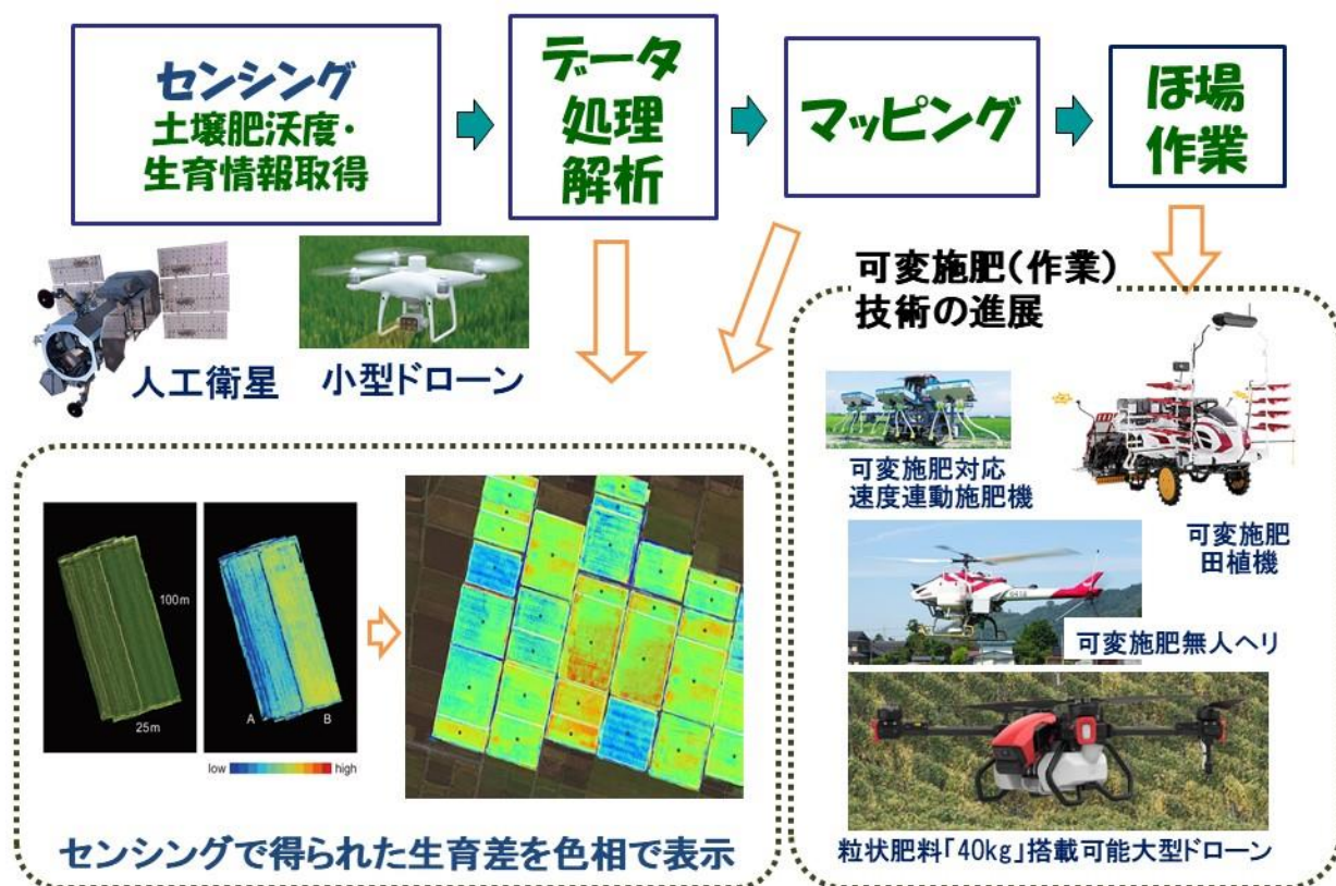
図 1 5 リモートセンシングから可変施肥に至る作業の流れ
