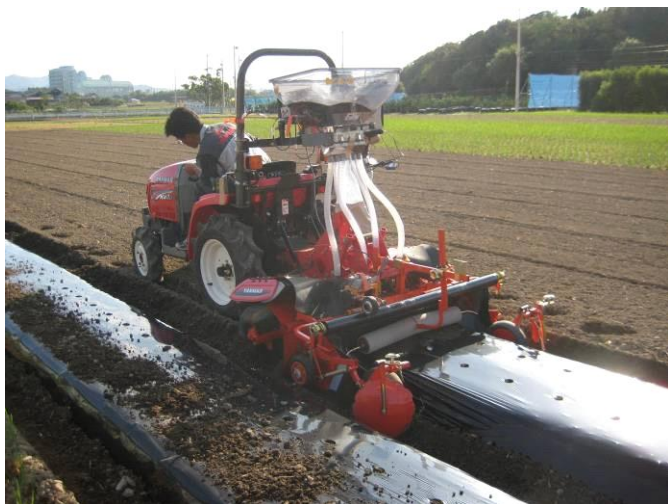
図 1 3 レタス作における畝立て・マルチ・局所施肥同時作業 (左：畝の浅層に肥料を混和 右：畝内局所施肥の例)
