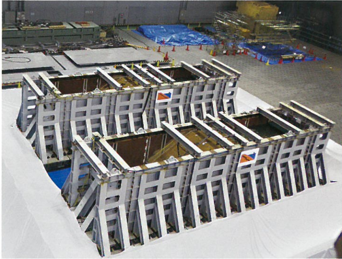
震動台の上に造成された2種類の堤体
