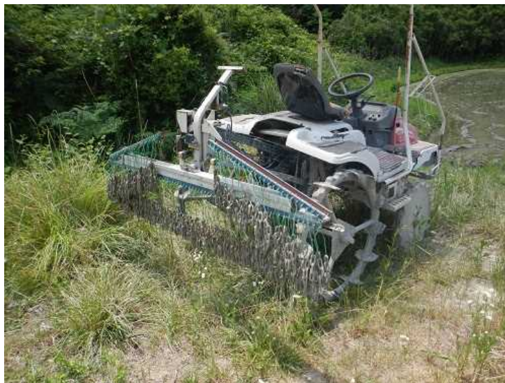
古い田植機を改造して自作したチェーン除草機
