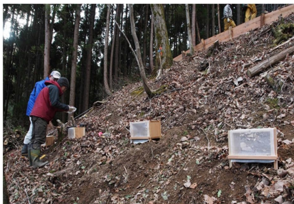
土砂受け箱の設置状況 (試験区下に土砂受け箱を設置し、 定期的に土砂回収)
