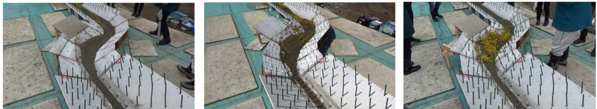
図 2-3 災害緩衝林の種類による森林内の流木捕捉状況 (a:緩衝林無し、b:整備前森林、c:目標緩衝林)
