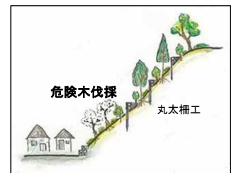
人家裏の危険斜面で危険木の伐採・簡易防災施設の設置
