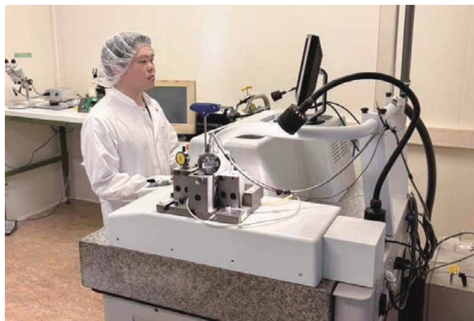
コンタクトレンズ専用のNC 旋盤を 操る村尾さん。対象物が小さいため、 高い集中心力と正確な加工技術が求 められる。
