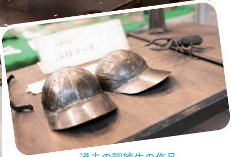
過去の訓練生の作品。 曲面も高精度で溶接されている。
