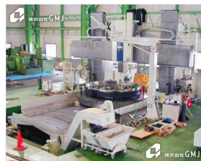
大型の門型マシニングセンタ（6軸同時制御）
