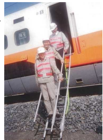
写真：「SUPER QUICK LADDER」 (ワン・ツー・スリーで組立完了、3分間で乗客脱出)
