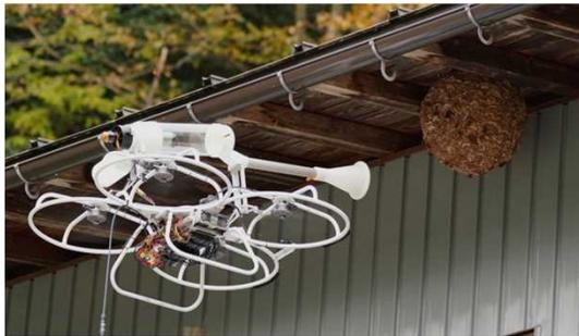
バキュームタイプのハチ駆除用ドローンを用いて、危険性の高いハチ駆除作業を、ハチ駆除件数が全国トップクラスの兵庫県において実施。
