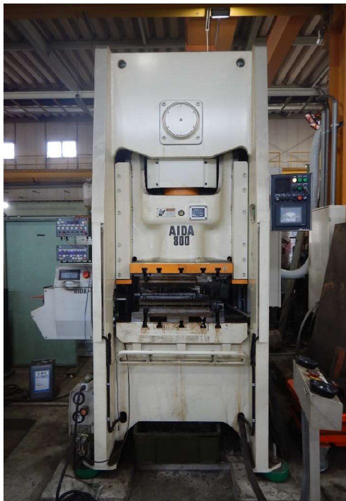
フィンチューブ加工の一つハイフレックスプレス
