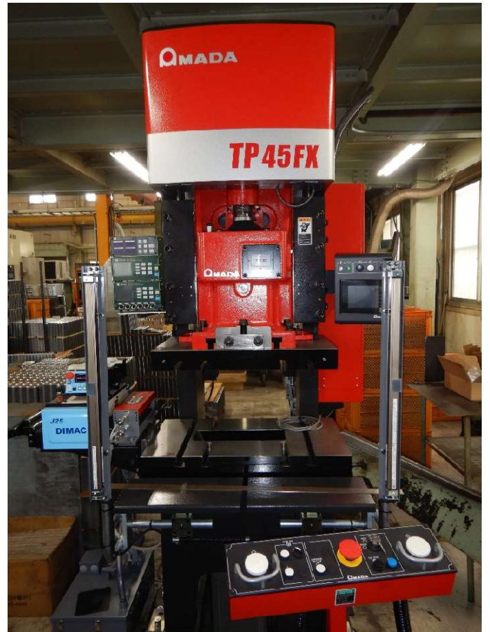
新設機械のシングルクランクプレス
