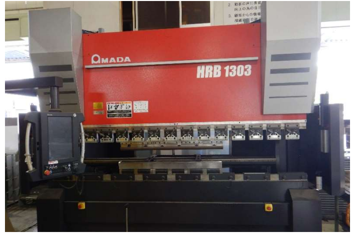
曲げ加工を行うベンディングマシン
