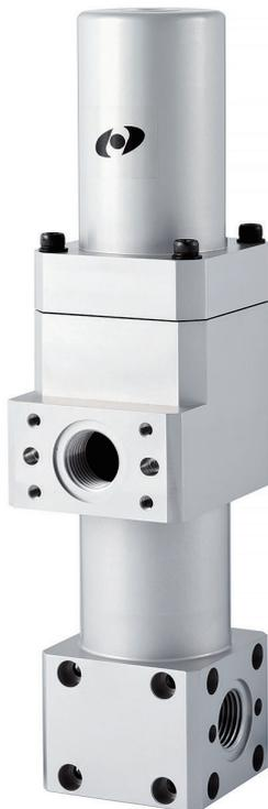
工業用接着剤はペール缶やドラム缶で販売されることが一般的であり、この接着剤を製品に自動塗布する場合には高圧ポンプを用い、ホースや金属配管を介して塗布機まで圧送しなければなりません。ポンプから塗布機までの配管が長い場合、高圧ポンプからの供給レスポンスが悪くなるため、アキュムレータを挿入しますが、アキュムレータ内で滞留した接着剤が経時劣化・固化するという不具合が生じます。本製品のFIFO<sup>®</sup>は「First In First Out」の頭文字をとったもの（商標登録済み）であり、工業用接着剤など高粘度材料の「先入れ先出し」構造を発明し製品化したものです。
