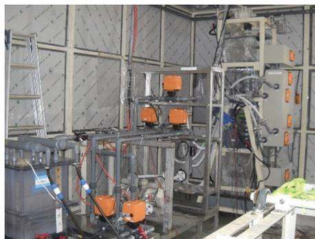
弊社は金属部材（タンク等）の表面処理加工等を行う企業であり、様々な部材の表面処理加工を行っています。この技術は、国際的な取り組みで日本が誘致を検討している大型加速器プロジェクトである国際リニアコライダー（ILC）に使用されるニオブ製超電導加速空洞管内面の電解研磨を高精度且つ低コストで行えるように開発したものです。さらに加速空洞管のみならず、様々な形状を持つ容器の内面電解研磨や電気鍍金（めっき）等に応用可能です。
