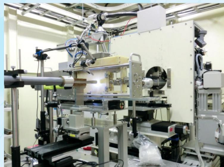
図2 BL19B2ラインでの世界最速引張・破壊試験（1m/s）同時X線散乱観察
