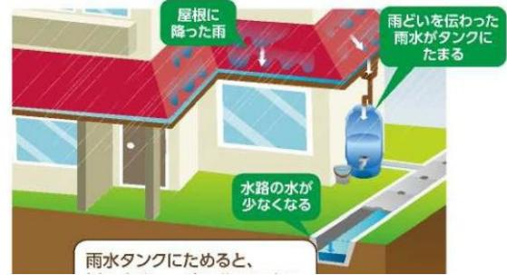
図 5-5 住宅等の小規模な建物等の雨水貯留・浸透のイメージ図
