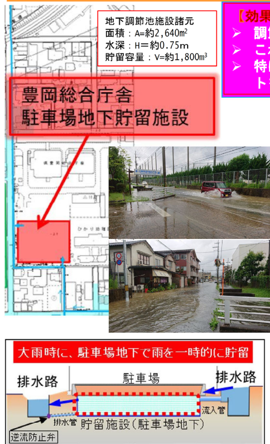
図 3-17 豊岡総合庁舎の地下調整池の整備効果検討
