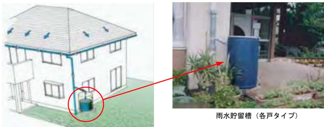
図 5.2.8 各戸貯留施設の例（地上タイプ）
