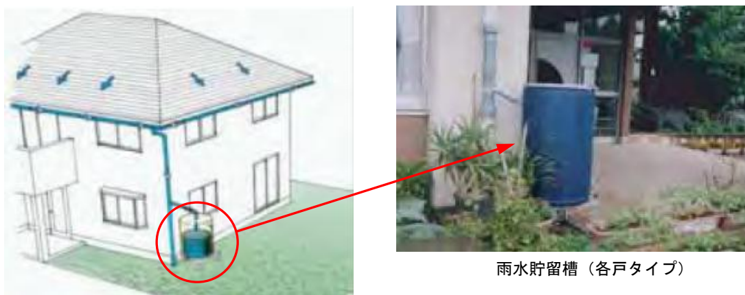
図 5.2.8 各戸貯留施設の例 (地上タイプ)
