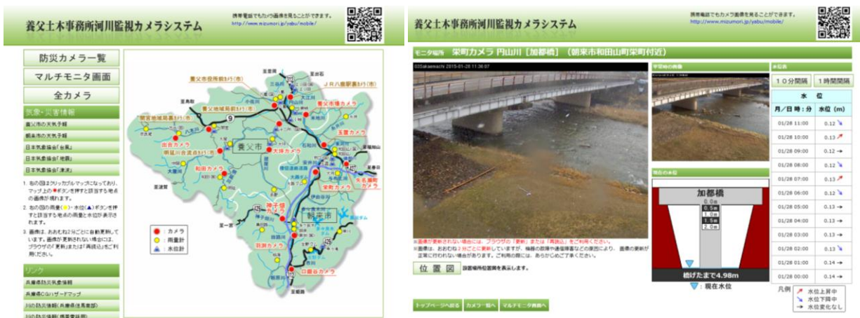
図 6.2.1 兵庫県河川監視システム（養父土木事務所河川監視カメラシステム）の例 （左：トップ画面、右：自動更新されるモニターカメラの映像例）
