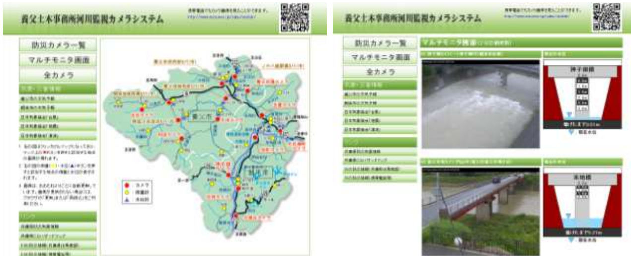
図 6.2.2 兵庫県河川情報システム（養父土木事務所河川監視カメラシステム）の例 （左：トップ画面、右：自動更新されるモニターカメラの映像例）
