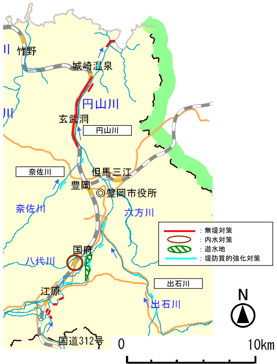
図 4.1.1 河川整備の内容（丸山川水系河川整備計画（国管理区間）より）
