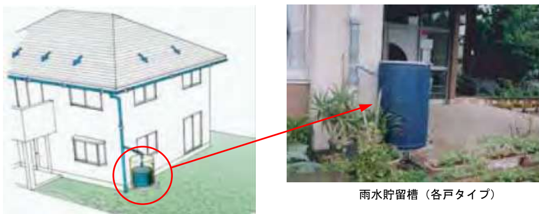
図 5.2.7 各戸貯留施設の例 (地上タイプ)
