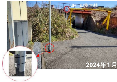
図 6-2 ワンコイン浸水センサーの設置・監視
