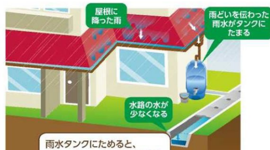
【雨水貯留タンク】
