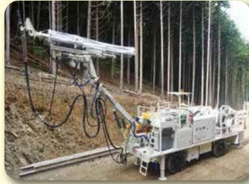
吹付機一体型 コンクリートを吹き付ける機械です。
