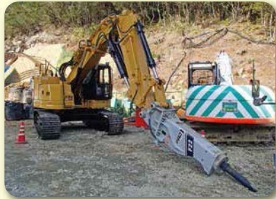
油圧ブレーカ トンネル掘削や発破によりゆるんだ岩盤を除去する機械です。
