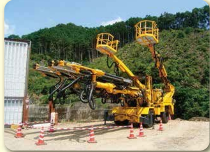
3ブームホイールジャンボ 発破やロックボルト施工のための削孔作業やトンネルの骨組となる支保工を設置する機械です。
