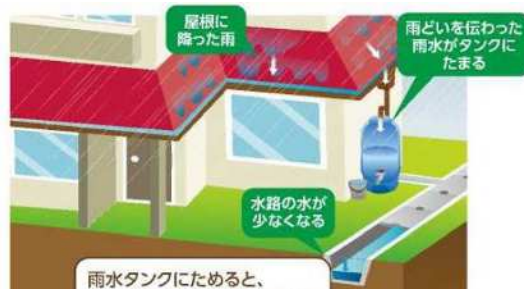
【雨水貯留タンク】
