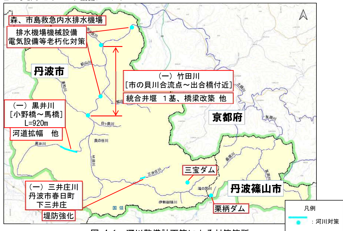
図 4-1 河川整備計画等による対策箇所
