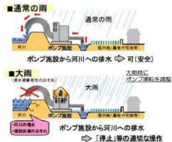
図 3-10 排水ポンプの運転調整
