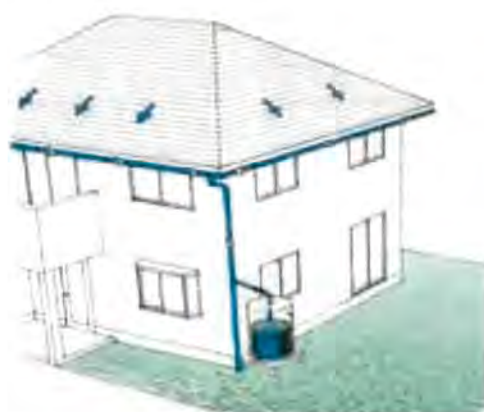
図 16 各戸貯留施設の例(地上タイプ)
