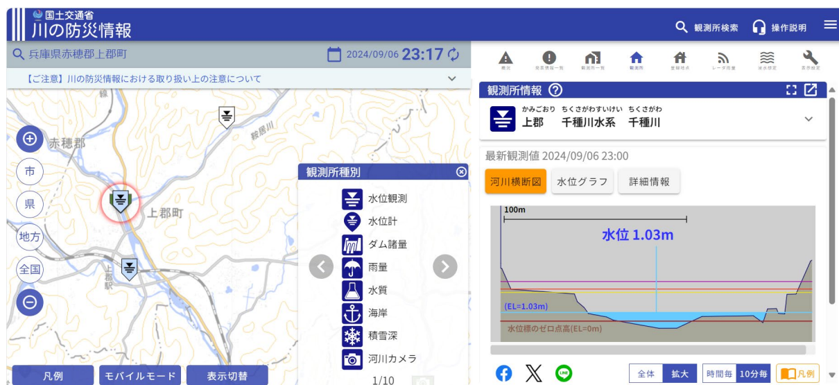
図 6-3.1 河川水位のリアルタイム観測情報例（川の防災情報）
