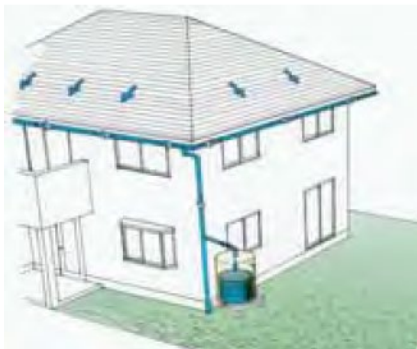
図 5-2.2 各戸貯留施設の例(地上タイプ)
