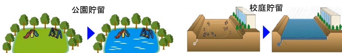
図 5-2.1 学校、公園等での雨水貯留対策のイメージ図
