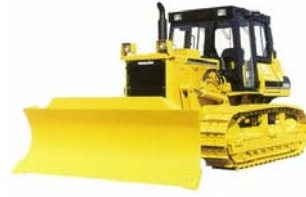
湿地用ブルドーザ(覆砂押土)
